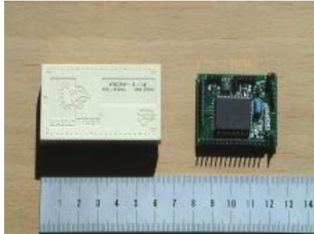
Microcontroller: links BASIC-Tiger, rechts C-Control
